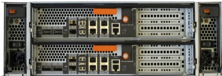
FAS3210 hátlapja, üres bővítő kártya helyekkel
